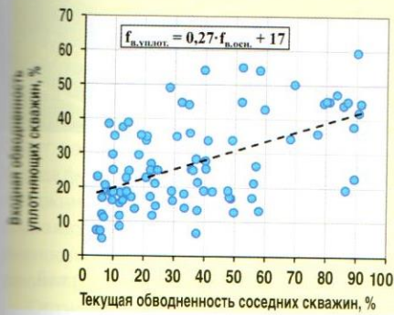
Рис. 5. Сопоставление текущей обводненности соседних скважин основного фонда и входной обводненности уплотняющих скважин
