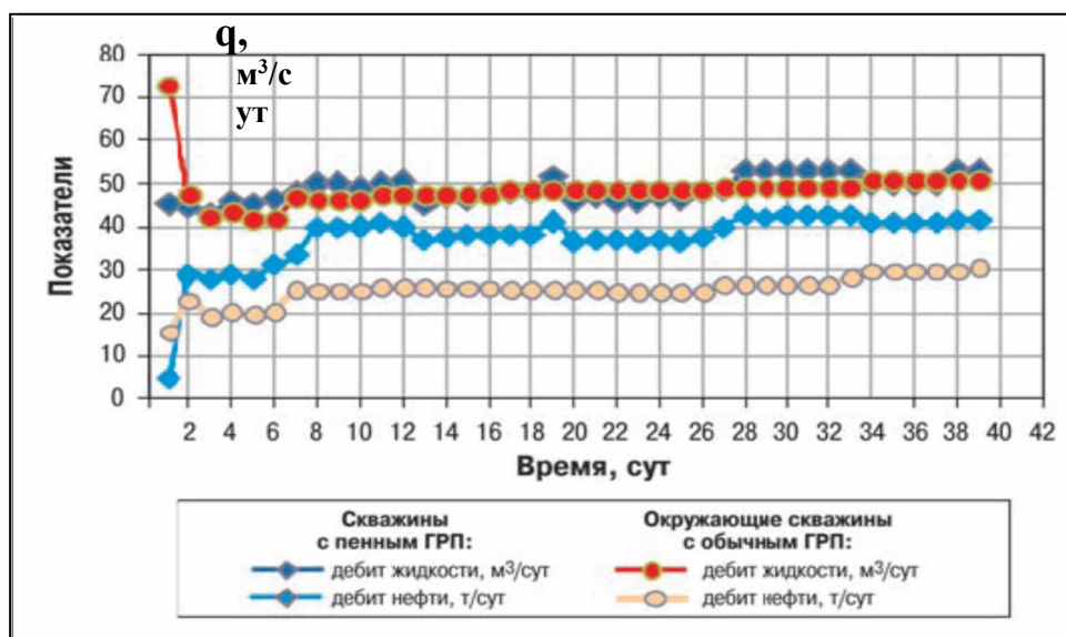
Рис. 3.6.5 Сравнение средних пусковых показателей по ранее работавшим скважинам с обычными пенными ГРП [31]
