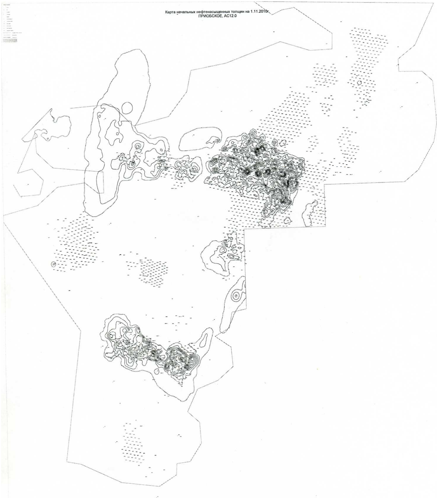
Рис.2.2.11 Приобское месторождение. Объект АС12 0 . Карта начальной нефтенасыщенной толщины на 1.11.2010. Источник: ООО "Газпромнефть НТЦ"
