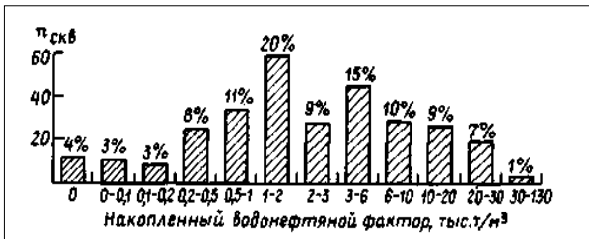
Рис. 17. Распределение добывающих скважин первых полос горизонта Б 10 по накопленному водонефтяному фактору
