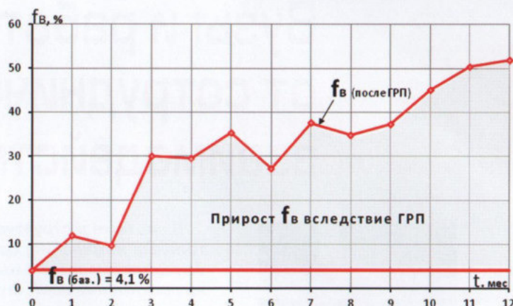
Рис. 6. График приростов обводненности по 5-ти скважинам в течение 12 «уплотненных» месяцев после ГРП
